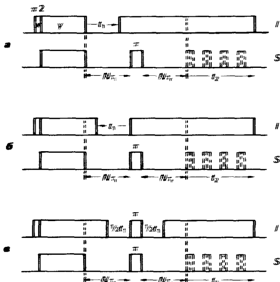
Рис. 7.3.8. Импульсные последовательности, применяемые в спектроскопии раздельных показываемых полос с вращением под магнитическим углом. а — простая схема, когда (\pi)^S -импульс синхронизируется с эхо-сигналом от вращения; регистрация сигнала начинается в момент возникновения чистого эхо-сигнала ( t = 2N\tau_{\pi} = 2N/\omega_1 , N = 1, 2, 3, \dots ); многотимпульсная последовательность, необходимая для подвысечения взаимодействий \mathcal{H}_0 в период t_1 , для ясности не показана; синхронные импульсы (указанные штриховыми линиями) в периоде регистрации позволяют, при желании, изменить масштаб изотропных химических сдвигов по \omega_2 для выполнения условия \omega_1 > \|\mathcal{H}_{\text{анх}}^{\text{анх}}\| ; б — аналогичный эксперимент с обрываемым временем, который с целью получения 2М-спектров чистого поглощения можно использовать в сочетании с последовательностью на рис. а ; в — «двухстороннее» эволюция, которая дает симметричное распределение боковых полос в области дипольных взаимодействий, с расстоянием между сигналами \Delta\omega_1 = \omega_1/2 [7.53].
